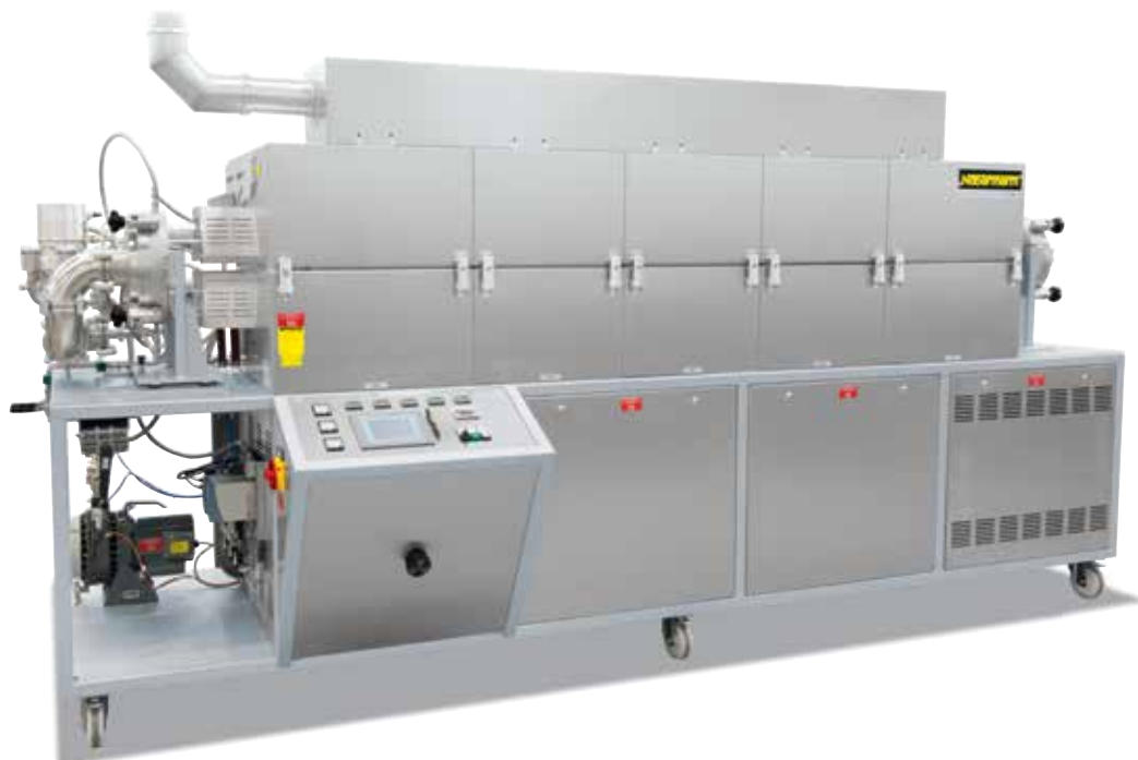
RS 250/2500/11S, controllo a cinque-zone, per la ricottura filo in alto vuoto o con gas protettivo, incl. ventilazione forzata e cappa aspirante
