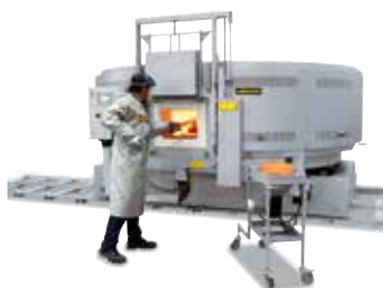
DH 2500/S su rotaie per il passaggio tra due forgiature
