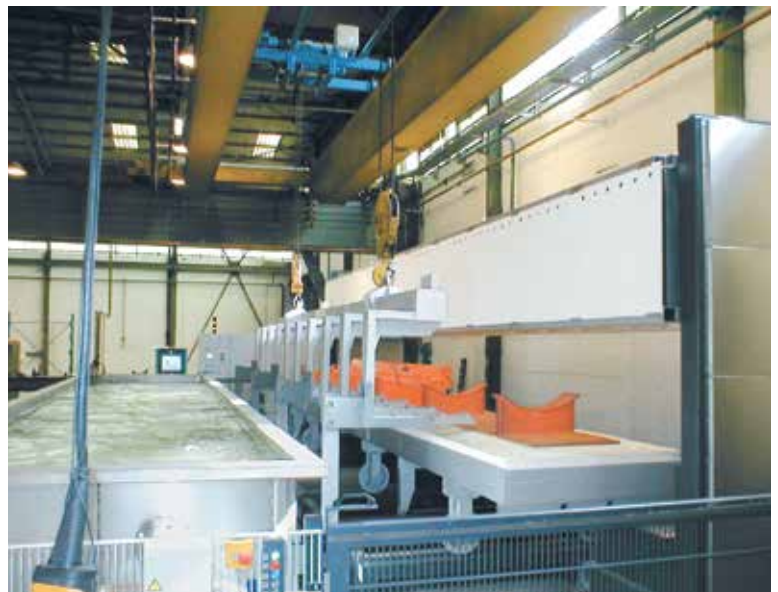
Impianto di bonifica manuale per la tempra di barre di acciaio vedi pagina 74/75
