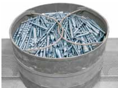
Ricottura blu di alesatori con vapore acqueo in un forno della serie NRA vedi pagina 14
