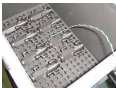
Sinterizzazione di componenti in titanio MIM in forni VHT
