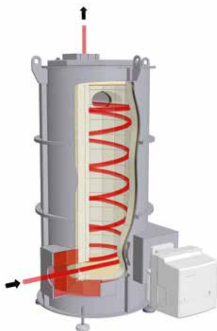
Rappresentazione schematica della post-combustione termica (TNV)
