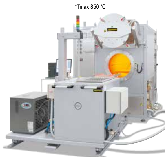
Impianto di bonifica semiautomatico con forno a storte NR 50/11 e bagno di raffreddamento ad acqua su un sistema a rotaie
