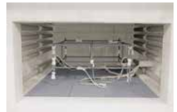
Struttura di misurazione in un forno di cottura
