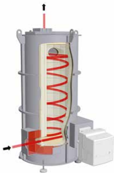
Rappresentazione schematica della post-combustione termica (TNV)
