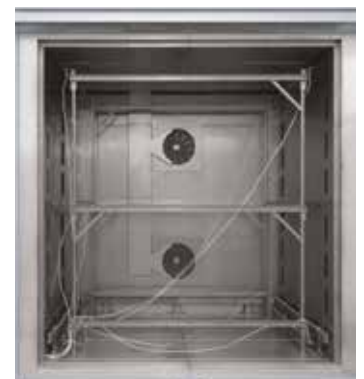
Telaio da assemblare per la misurazione nel forno a circolazione d'aria N 7920/45 HAS
